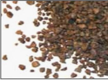
Producto obtenido durante el reciclado de las placas de *Aglocork Térmico*. El material se tritura formando el granulado, que mantiene todas las características aislantes de la placa original. Se puede aplicar directamente entre tabiques o bien mezclar con cemento, arena y agua para la construcción de soleras aislantes. Buen aislante térmico y muy eficaz para el aislamiento de ruidos aéreos.
